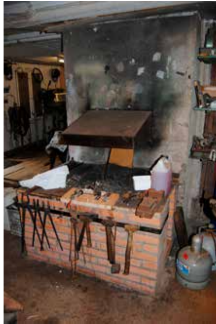
Den centralt placerade murstocken med ässjan.
