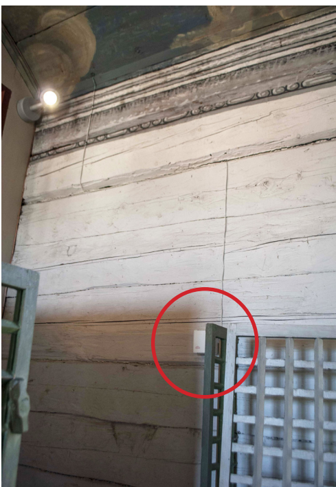
Ovanför den bakersta bänken, på väggen in till förrådet, satt en givare för mätning av luftfuktighet.
