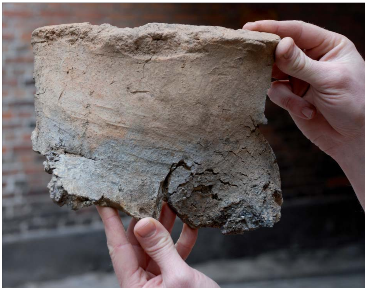
Figur 18. Delar av ugnsväggen. De sintrade partierna tyder på att ugnen överhettats. Foto: Lennart Carlie.
