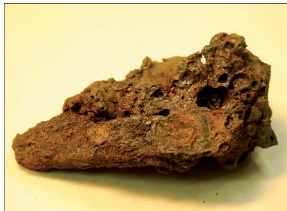
Figur 15. Slagg med inneslutet järnstycke. Foto: Leif Häggström.
