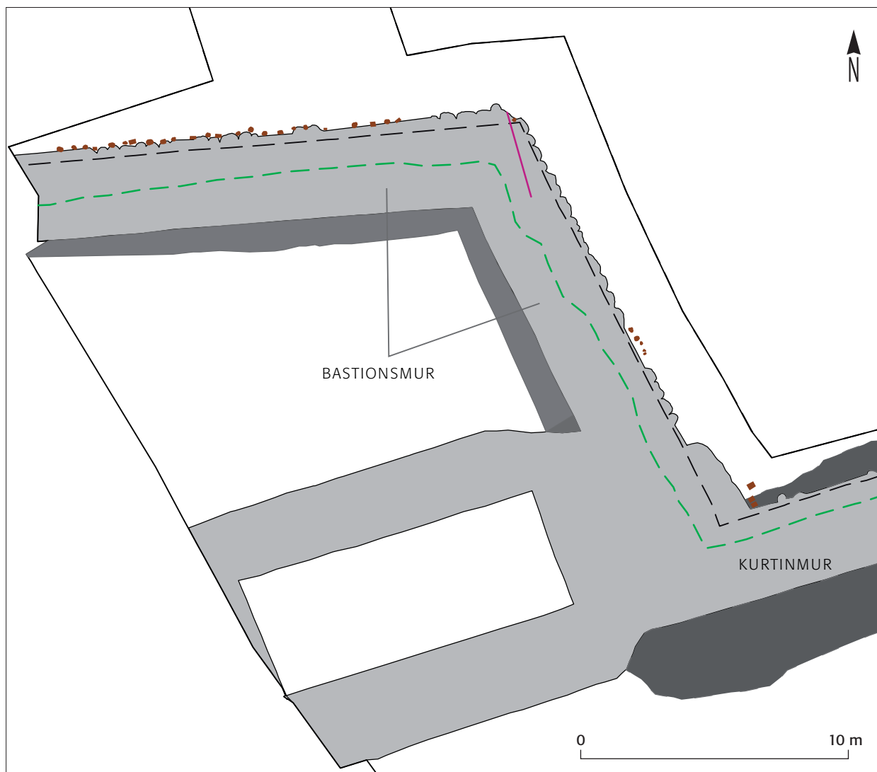
Fig 18. Plan över nedgrävningar för kurtinmur och bastionsmur. Den gröna streckade linjen markerar gränsen mot den nedbrutna ytersidan, den svarta streckade linjen är murarnas sträckning, de utanför markerade murdelarna är grunderna och de bruna "fläckarna" markerar träpålar. Öster om den röda heldragna linjen är muren skadad av en yngre nedgrävning för en 1800-talsbyggnad. Skala 1:200.
