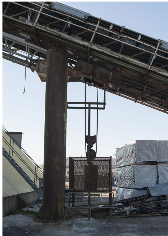
Det finns även ett transportband från kajkanten i väster som leder in materialet i silorna.
