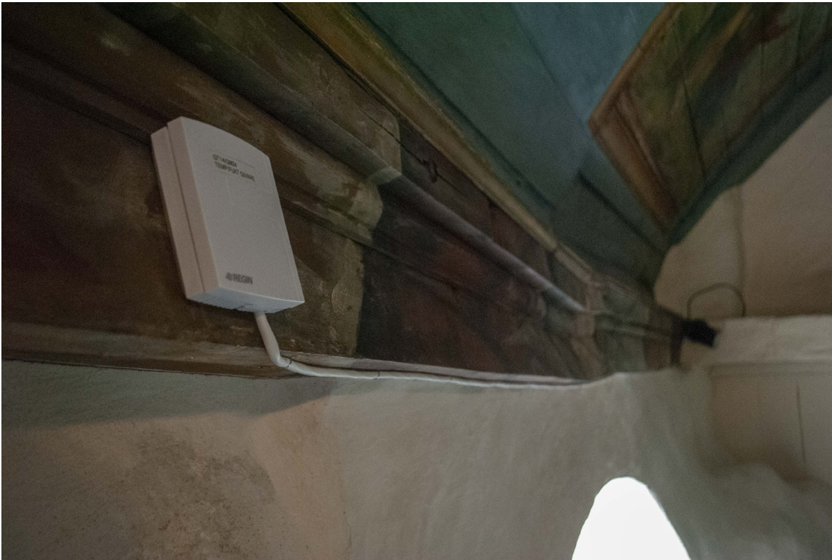
Givare på takfotslisten uppe på läktaren, som mäter relativa luftfuktigheten i zon 3.
