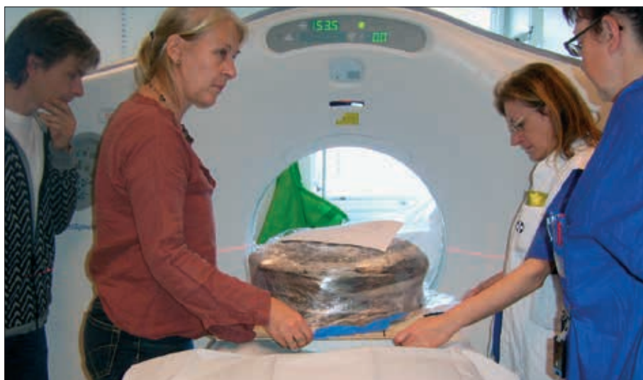
Fig. 5. Kitteln togs till Sahlgrenska Sjukhuset i Göteborg där den röntgenansvariga intresserats för fyndet och kitteln skiktröntgades i 2 mm:s intervall, horisontellt och vertikalt.
