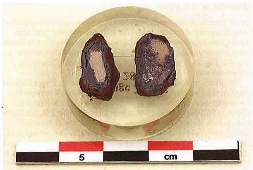
Figur 3. De båda delade proven HM 28666:19 och HM 28666:27 efter ingjutting i plastpuck, polering och etsning.
