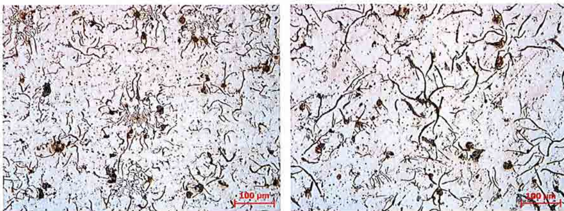
Figur 4a, b. Före etsning ses grafitlamellerna, som innehåller rent kol, som oregelbundna mörka trådar i det ljusa järnet. HM 28666:19 vänster (a), HM 28666:27 höger (b). Observera att bilderna har samma skala och att HM 28666:27 är mer grovkornig med längre och bredare grafitlameller.
