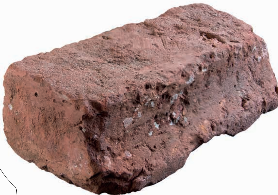
Fig 72. Formtegel med hålkälad urfasning utmed långsidan (fnr 325). Foto och profil: Anders Andersson.
