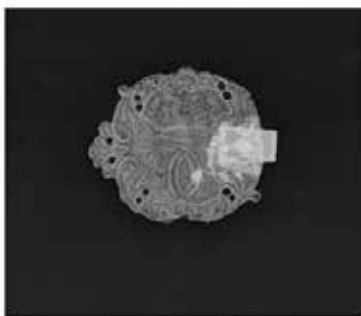
Röntgenbild av emblemet. Det framkommer tydligt spåren från tennlodet.
