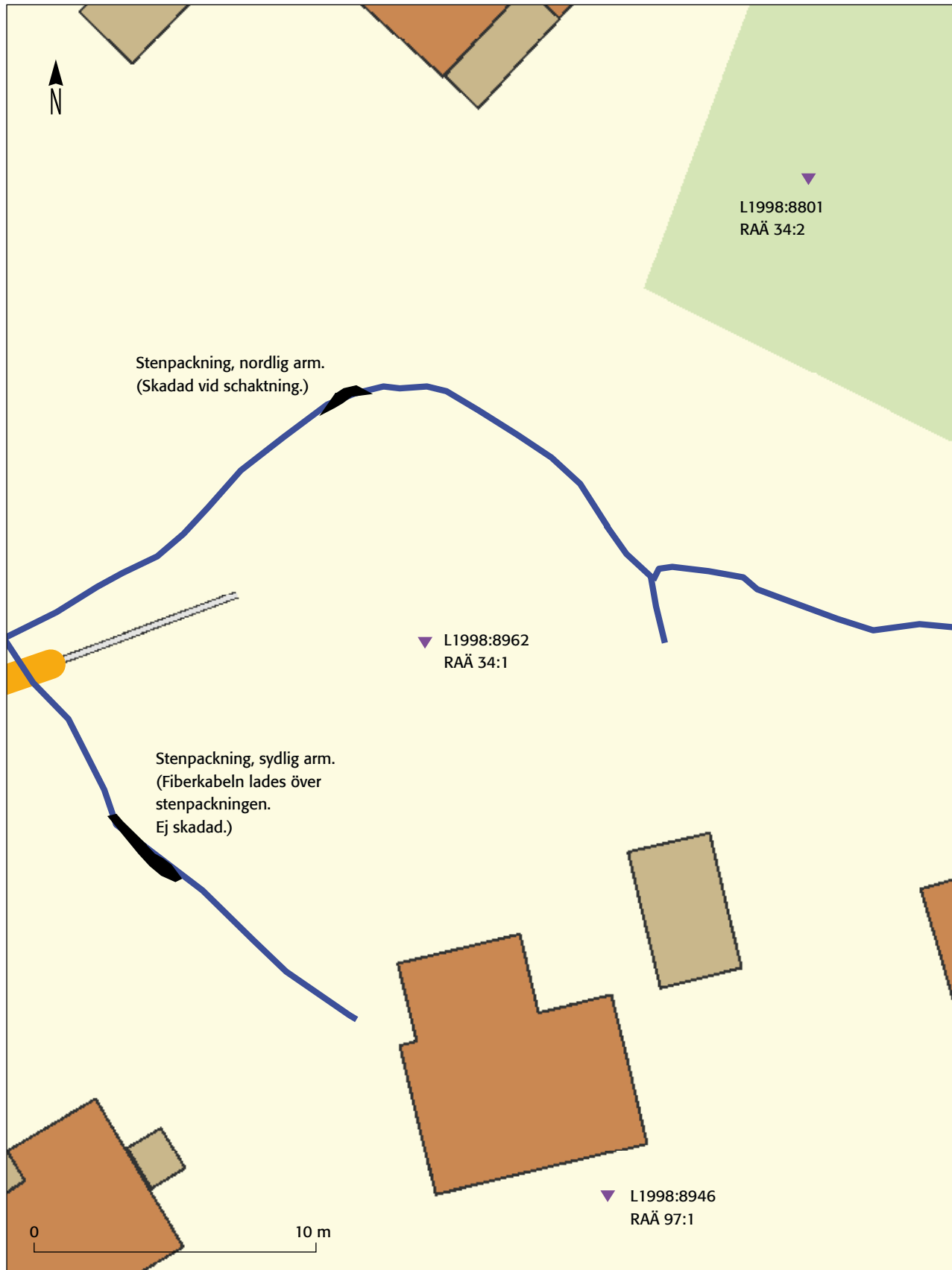
Figur 4: Schaktens läge (blå) vid treuddarna i områdets norra del. Den norra armen på den södra treudden skadades vid schaktning, varför fiberkabeln förlades över dess södra arm. Skala 1:200.
