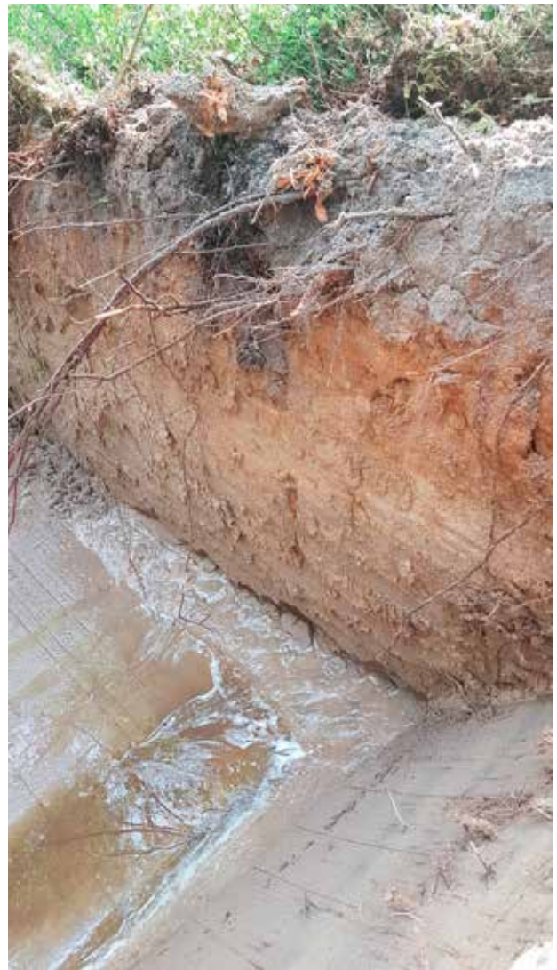
Fig 3. Schakt 425 mot nordväst. Finsand som under den humösa jordmänen visar på järnutfällning. På 1,1 meters djup nås grundvatten Foto 2022-41-9.
